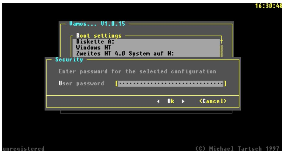
Die Konfiguration des Bootmanagers erfolgt in verschiedenen Unter-Menüs. Der Konfigurationsmodus kann durch ein Hauptpasswort geschützt werden.
